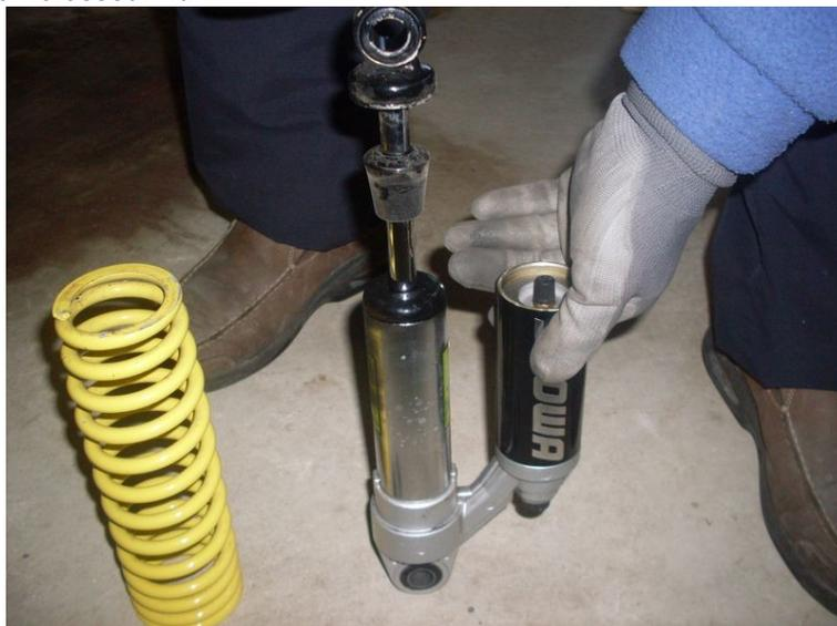
Afin de le serrer correctement dans l'étau, je conseille de retirer la bague amortisseur sur la tête. Pour ce faire j'ai utilisé une douille de cliquet à la bonne taille. Ensuite vous pouvez serrer l'amortisseur dans l'étau tête en bas en prenant soin de mettre des protections sur les mors de l'étau pour ne pas abîmer l'alu.
