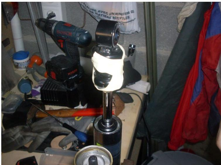
Voilà le bas du piston. Il est maintenu par un circlips qu'il va falloir enlever.
