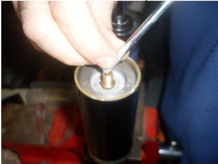
Maintenant qu'il n'y a plus de pression avec l'aide d'un gros tournevis plat et d'un marteau, vous tapez délicatement sur le piston pour le faire descendre d'un ou deux centimètres.
