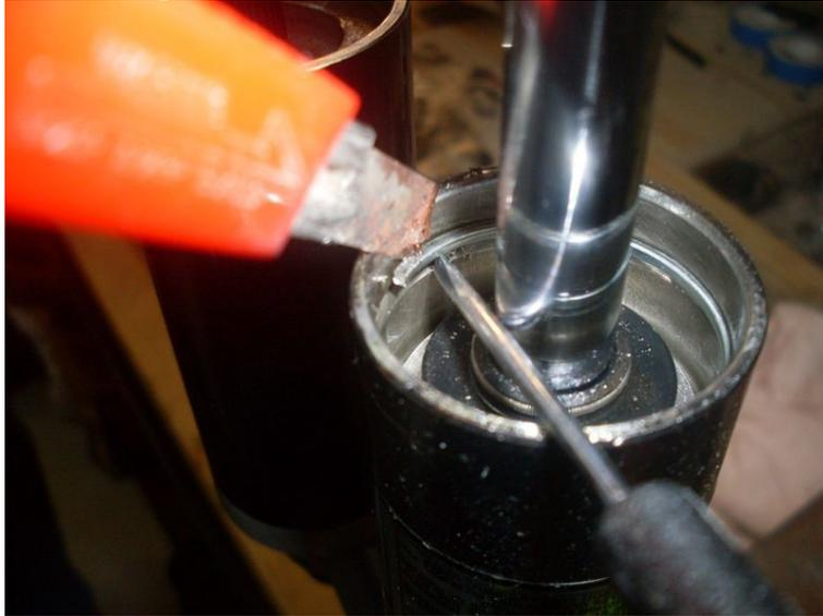
Voilà le circlips sorti. Maintenant le piston va pouvoir sortir facilement.
