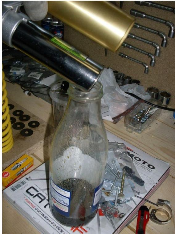
Voici l'ensemble piston. Il va falloir tout démonter. Pour cela clé à pipe de 14 après avoir éliminé à la lime, le matage qui est fait en bout de tige pour éviter que l'écrou ne se dévise.
