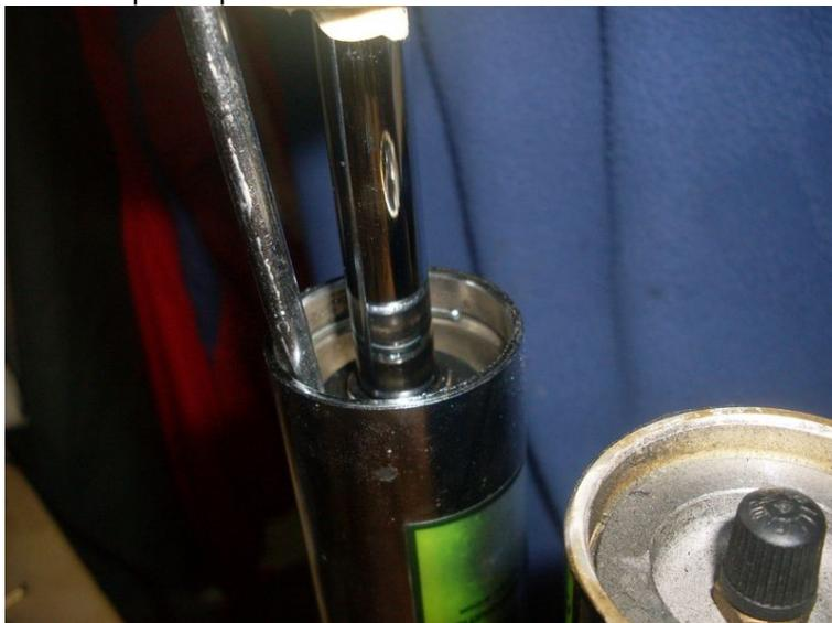
A l'aide d'une lame de cutter, vous passez derrière le circlips. Puis vous mettez la lame du cutter dans la gorge du circlips et à l'aide d'un petit tournevis vous faites remonter le circlips et ensuite vous l'attrapez avec vos doigts et le sortez.
