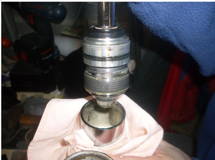
Vous faites la même manip du côté de la bonbonne d'azote et en vous aidant d'une pince, vous tirez sur la valve pour sortir la chaussette en caoutchouc qui renferme l'azote. Mettez un bouchon sur la valve pour ne pas abîmer le filetage.
